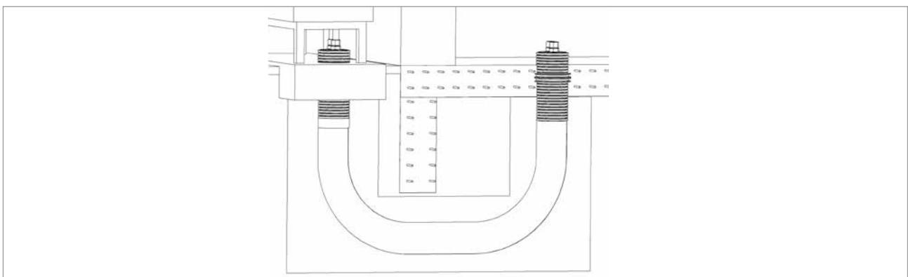
Abb. 6.3.2: Schematische Darstellung Bodenplattendurchführung
