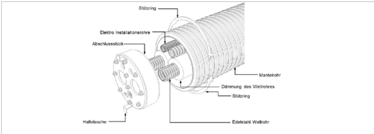
Abb. 6.4: Abschlussstück Mantelrohr
