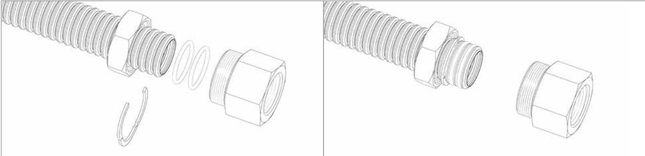
Abb. 6.5.1: Rohranschluss C-Clip
