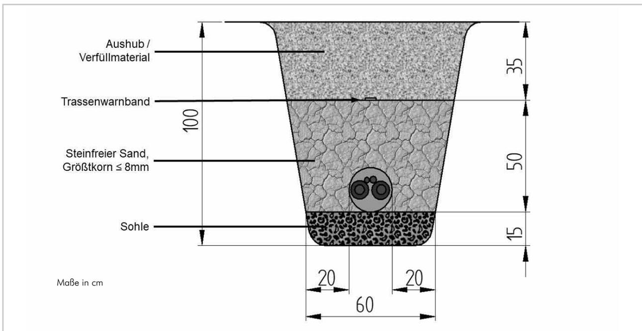
Abb. 4.4: Einbettung des Mantelrohres
