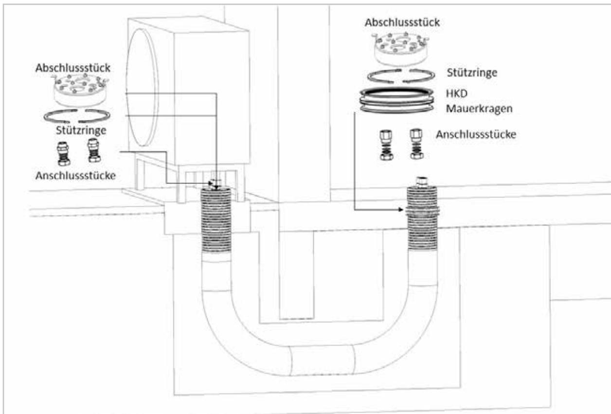
Abb. 3.2: Typ Bodenplatteneinführung
